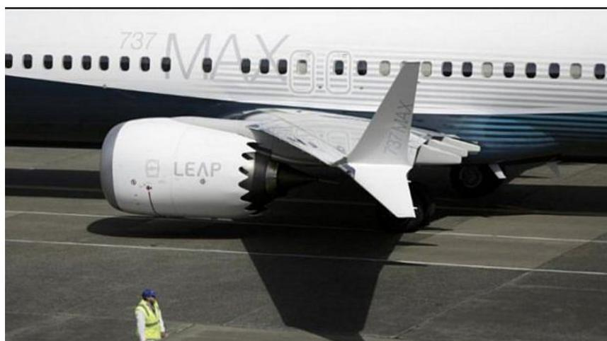
Pour installer ce moteur à la fois plus lourd et plus gros sans changer l'aile, il fallut « tricher » en le déportant entièrement vers l'avant de l'aile, tout en procédant à une légère modification du train d'atterrissage. Cette avancée du moteur représentait une modification majeure pour cet avion et induisait une grosse part d'inconnu quant à ses nouvelles caractéristiques de vol.
