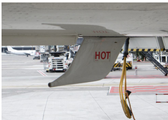
Drain d'évacuation d'eau des lavabos.
