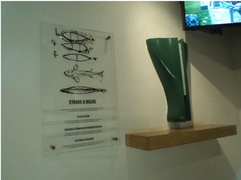
**L'étrave à bulbe pour les bateaux, permettant de réduire la résistance de l'eau**
