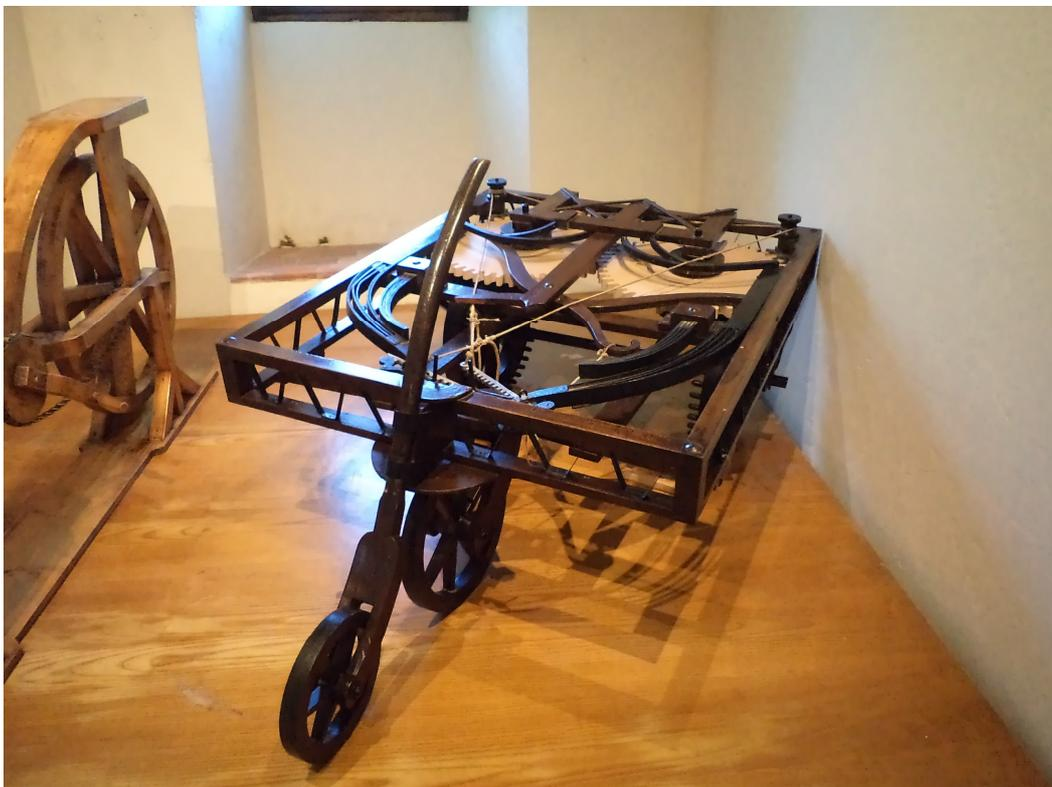
**Le véhicule automouvant, roulant grâce à des ressorts, ancêtre de l'automobile**
