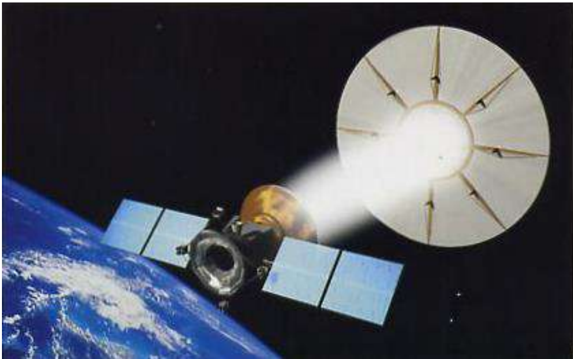
Fig.59 – Un laser basé au sol, sur orbite ou dans l'espace fournit l'énergie pour pousser la voile. La station laser tire son énergie d'un réacteur nucléaire compact ou d'un générateur isotopique selon la puissance à fournir.
