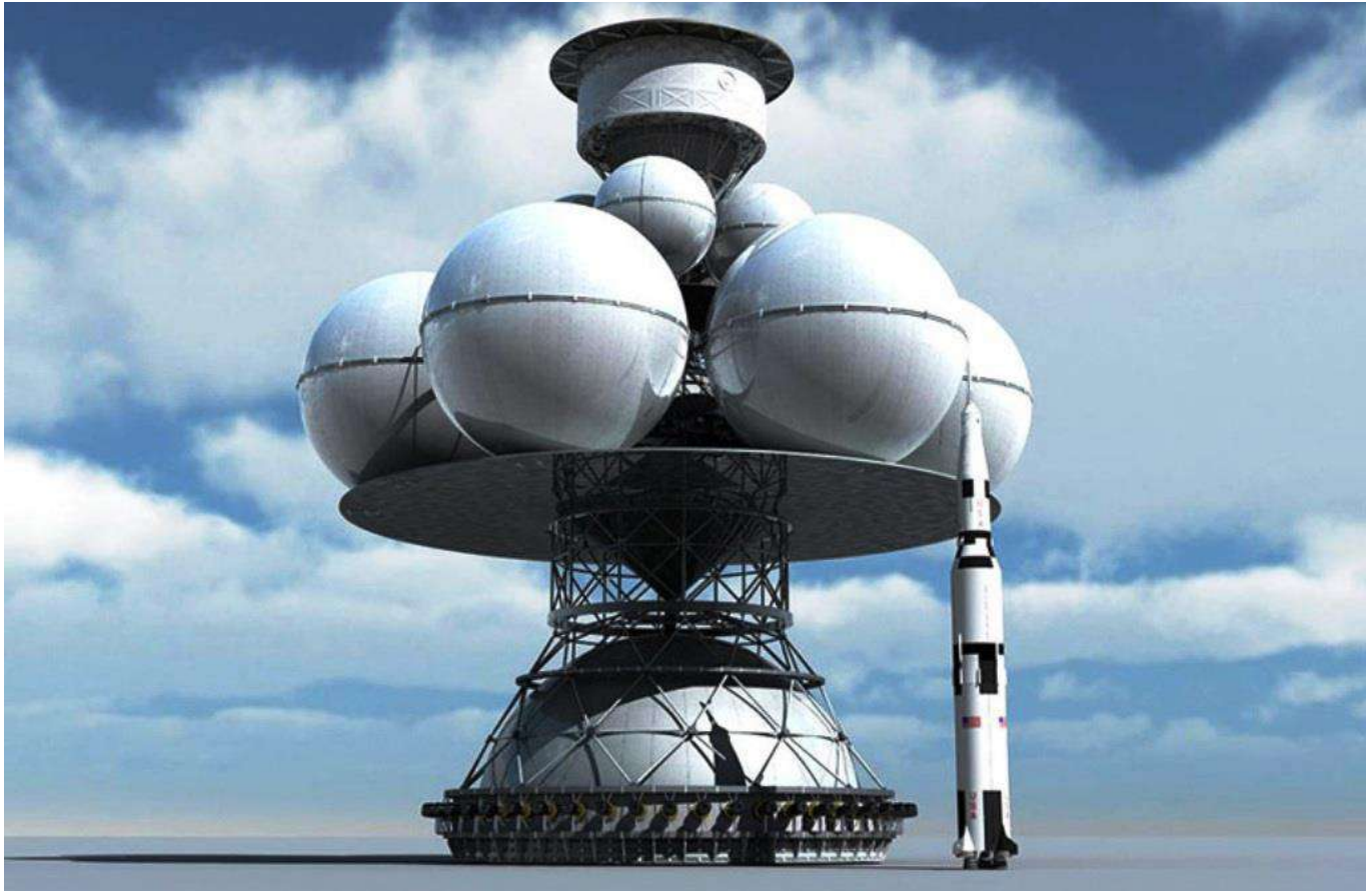
Fig.38 – A gauche, le Projet Daedalus, comparé à la fusée Saturn V qui a permis d'aller sur la lune. Daedalus est un concept de 1978 pour réaliser une sonde interstellaire non pilotée devant être lancée en 1998 et atteindre l'incroyable vitesse de 130 millions de km/h. Jusqu'à présent tous les projets sont limités par la vitesse de la lumière, ce qui signifie que pour les observateurs restés sur Terre, la perception du temps de transit interstellaire des engins va porter sur des décennies, des siècles sinon plus.
