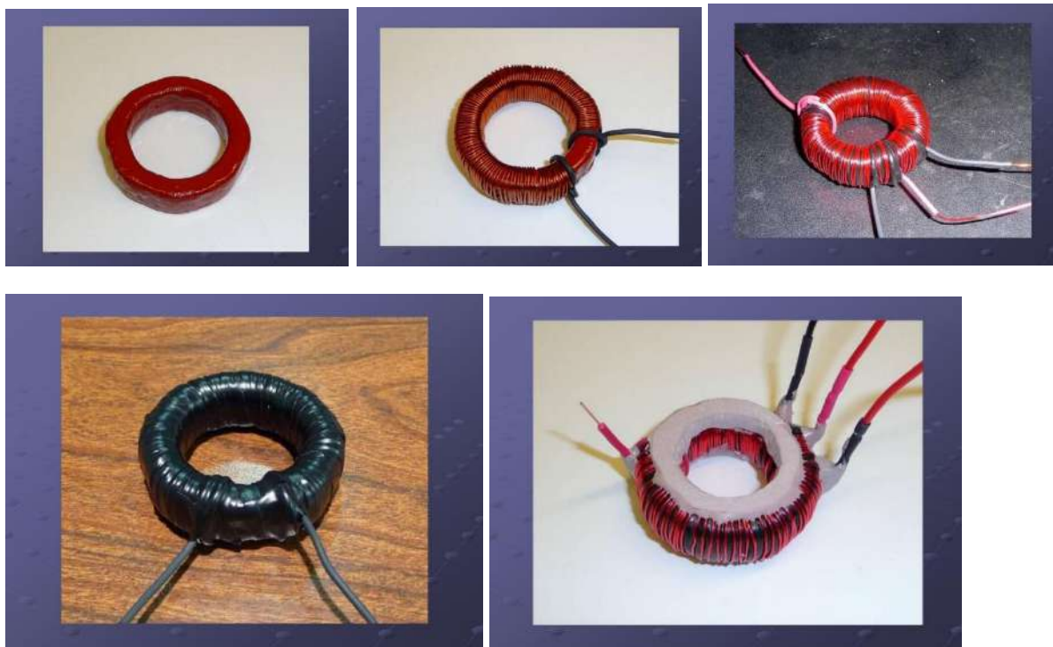
Fig.287 – Les étapes de la fabrication d'une bobine/transformateur
